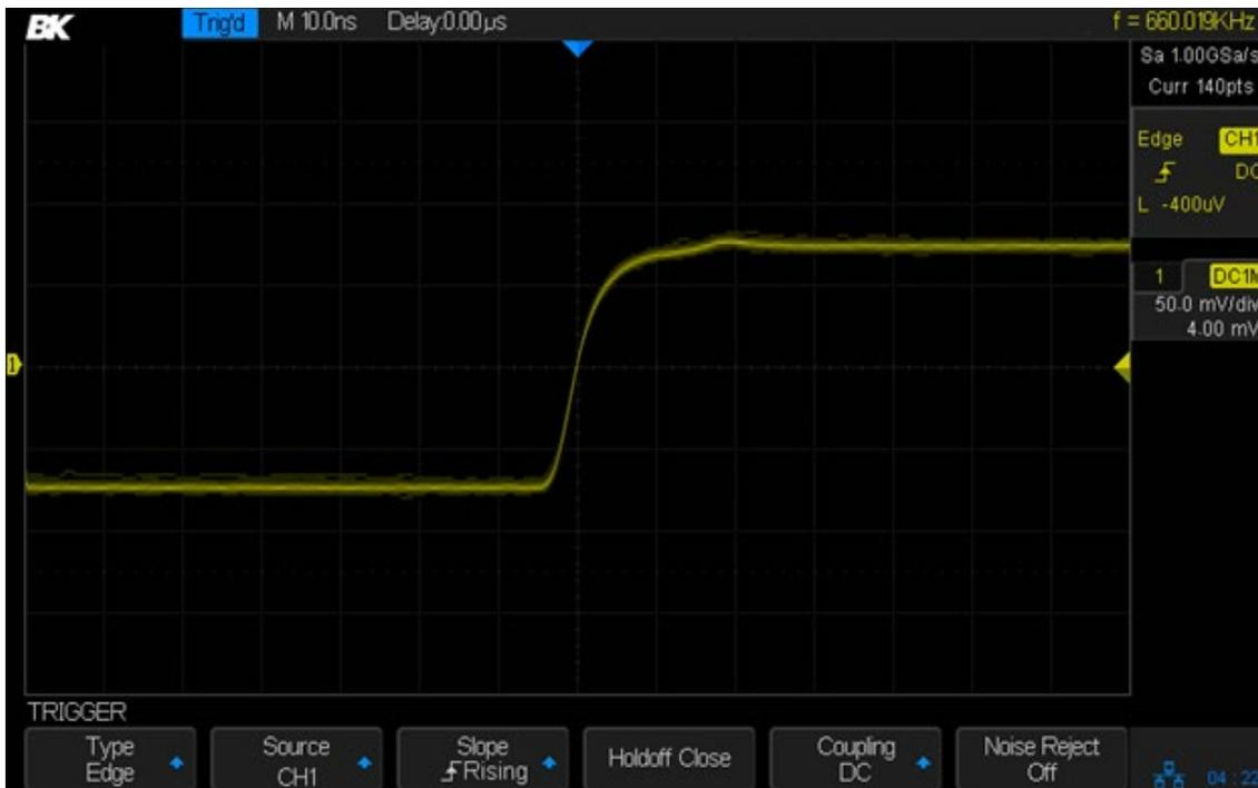
Figure 49 - Edge trigger
