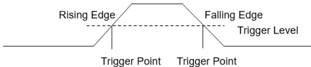
Figure 48 - Edge trigger
