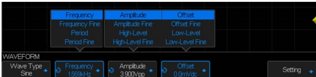
Figure 133 - Waveform parameters
