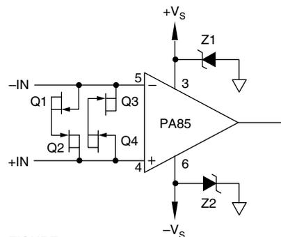
FIGURE 2. OVERVOLTAGE PROTECTION
