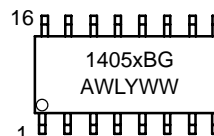
SOIC-16 D SUFFIX CASE 751B
