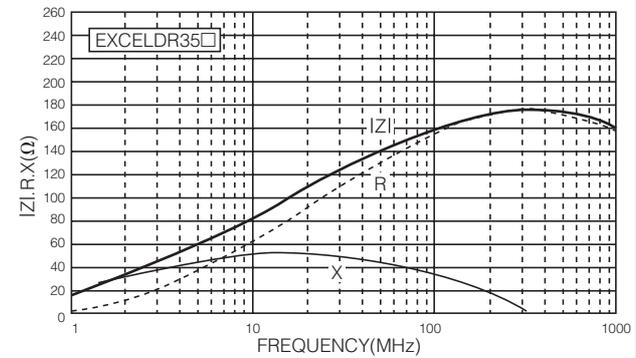
$|Z|$  : Impedance ( $\Omega$ )   R : Resistance ( $\Omega$ )   X : Reactance ( $\Omega$ )
