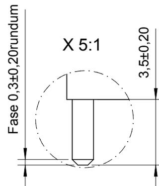
Oberfläche 5-10µm Sn über 2-4µm Cu®
