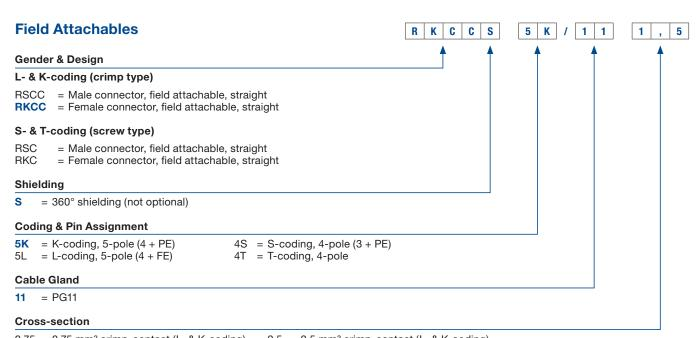
0,75 = 0.75 mm<sup>2</sup> crimp-contact (L- & K-coding)
