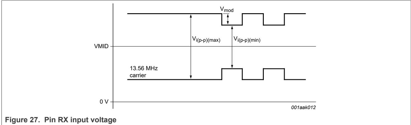
Figure 27. Pin RX input voltage
