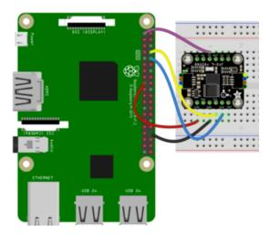
Pi 3V3 to sensor VIN (red wire)
