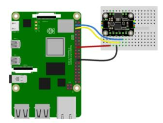
Pi 3V to sensor VIN (red wire)
