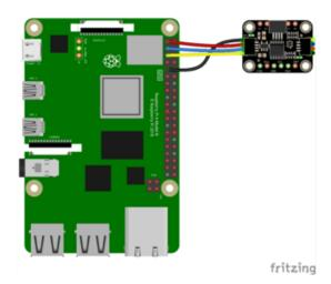
Pi 3V to sensor VIN (red wire)
