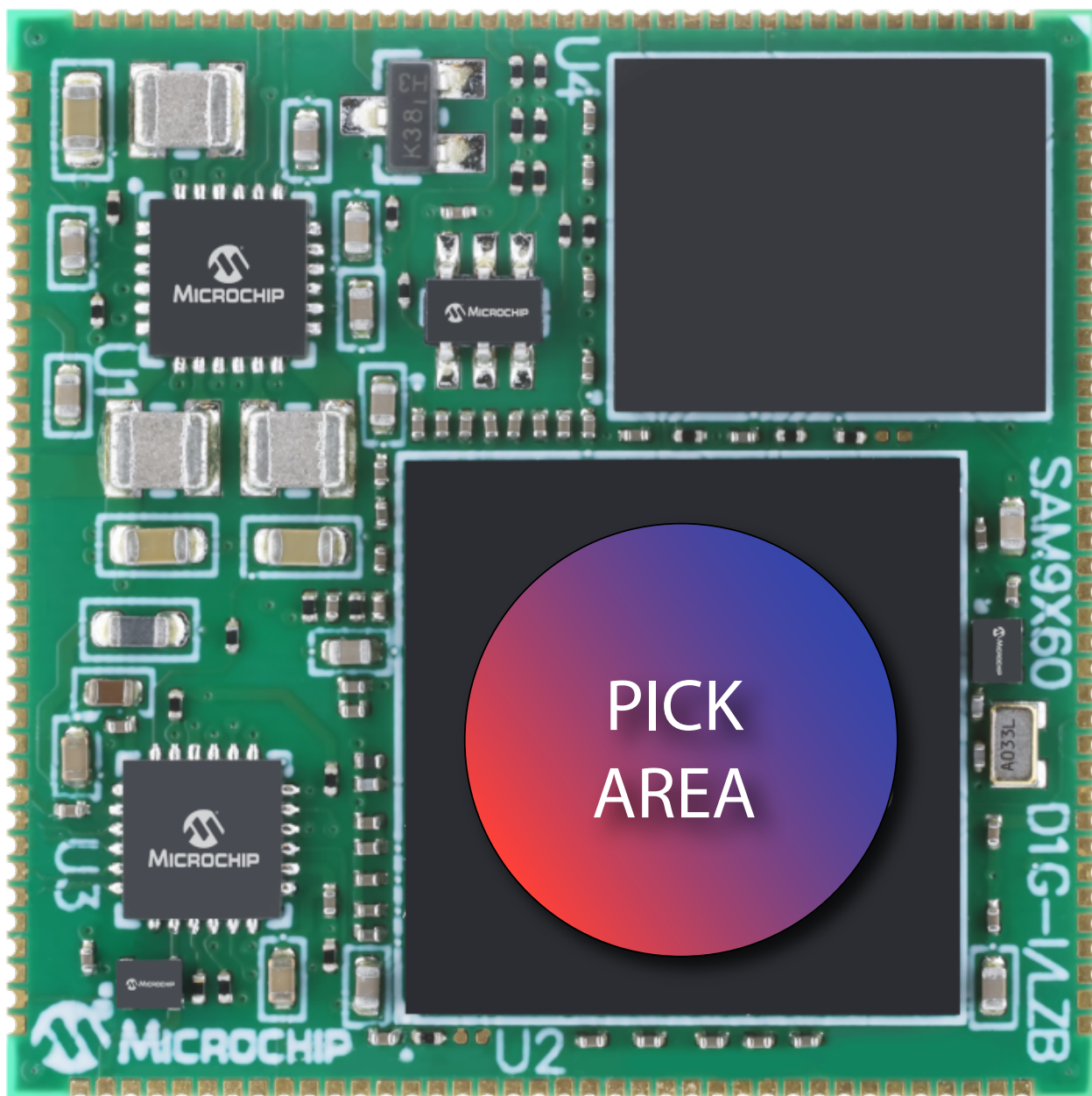
Figure 4-1. SAM9X60D1G SOM Pick & Place Area
