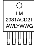
D2PAK D2T SUFFIX CASE 936A
